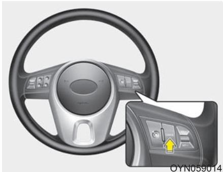
**Отменить работу круиз-контроля можно одним из следующих способов:**
