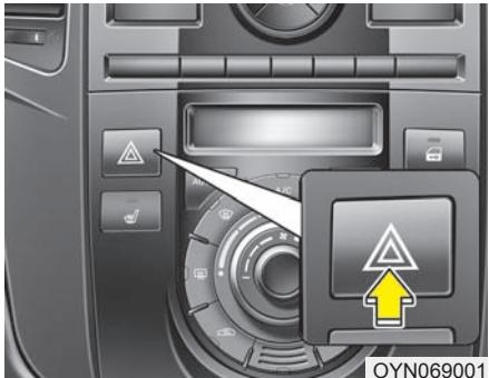
Система световой аварийной сигнализации должна использоваться всегда при остановке автомобиля в небезопасном месте. Во время аварийной остановки следует сместиться с проезжей части как можно дальше.
