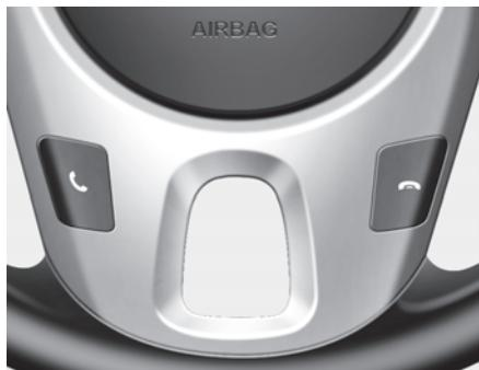
**Пульт управления аудиосистемой на рулевом колесе с одним назначением кнопок\***
