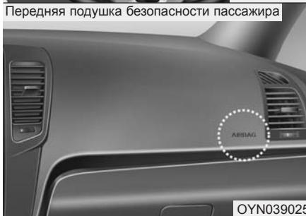
На ее наличие указывает рельефная надпись AIR BAG на крышке подушки безопасности на рулевом колесе и на элементе передней панели над перчаточным ящиком со стороны пассажирского сиденья.
