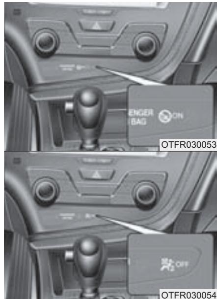
Переключатель для включения/отключения передней подушки безопасности пассажира
