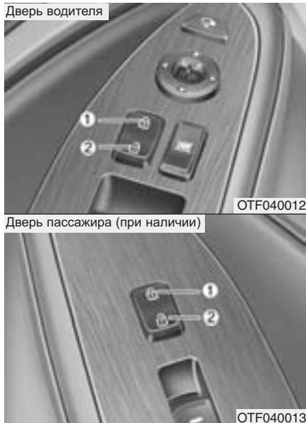
**Автомобили, оборудованные переключателем централизованного управления замками дверей (при наличии)**
