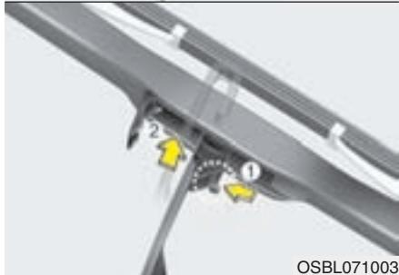
2. Поверните фиксатор щетки стеклоочистителя. Затем поднимите фиксатор стеклоочистителя.
