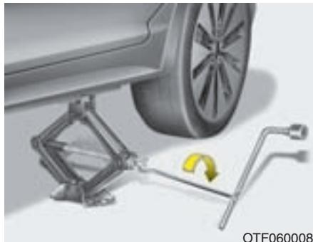
8. Вставив рукоятку домкрата и поворачивая ее по часовой стрелке, поднимайте автомобиль до тех пор, пока колесо не оторвется от земли. Это расстояние составляет примерно 30 мм (1,2 дюйма). Перед тем как откручивать колесные гайки, убедитесь в устойчивости автомобиля и в отсутствии возможностей его передвижения или соскальзывания.
