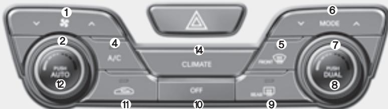
1. Регулятор частоты вращения вентилятора
