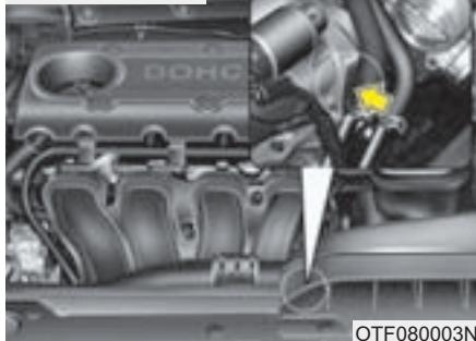
Серийный номер двигателя выбит на блоке цилиндров, как показано на рисунке.
