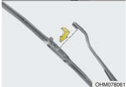
2. Поднять зажим щетки стеклоочистителя. Затем опустить щетку в сборе и снять ее.
