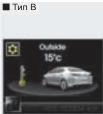
Чтобы изменить единицы отображения температуры наружного воздуха (с °C на °F), нажать и удерживать в этом режиме кнопку RESET больше 1 секунд.
