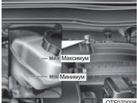
Если уровень низкий, долейте жидкость до отметки "MAX (МАКСИМУМ)". По мере увеличения пробега уровень будет снижаться. Это связано с состоянием накладок тормозов и не является признаком неисправности. Если уровень жидкости чрезмерно низкий, необходимо, чтобы авторизованный дилер компании Kia произвел проверку состояния тормозной системы.
