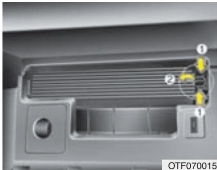
3. Снимите крышку воздушного фильтра климат-контроля, нажав на фиксатор справа.
