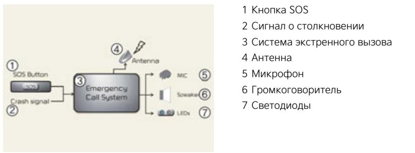
Обзор автомобильной системы автоматического оповещения о дорожных происшествиях на автотранспорте на базе службы 112, ее работа и функциональные возможности: см. данный раздел. Служба автоматического оповещения о дорожных происшествиях на автотранспорте на базе службы 112 является общедоступной государственной службой и доступна бесплатно.
