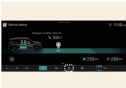
Выберите значок на экране информационно-развлекательной системы, запланированную зарядку и желаемую температуру.
