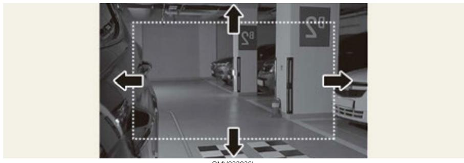
Экран монитора цифрового бокового зеркала можно настроить на переключение в широкоугольный режим при переключении рычага коробки передач в положение R. При переключении в режим широкоугольного обзора одновременно отображаются направляющая линия, позволяющая следить за парковочной разметкой рядом с вами, а также за боковой/задней парковочной разметкой.
