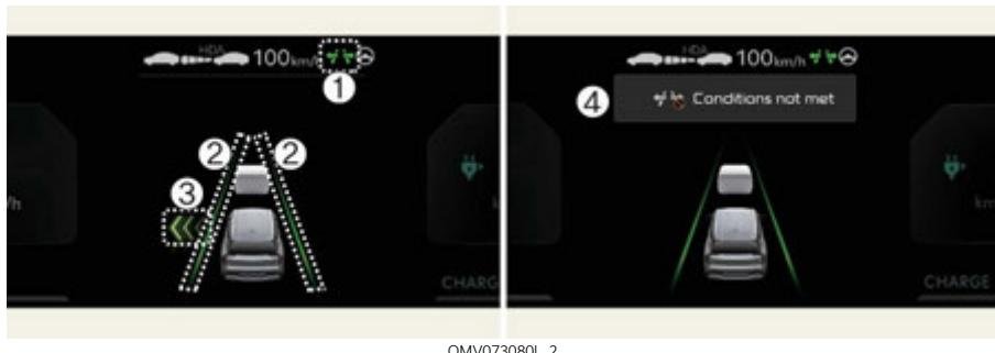
Сигналы функции помощи при смене полосы движения на автостраде отображаются как показано ниже, в зависимости от состояния функции.
