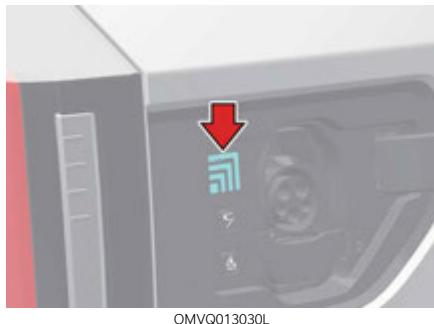
При зарядке высоковольтного аккумулятора уровень заряда можно проверить снаружи автомобиля.
