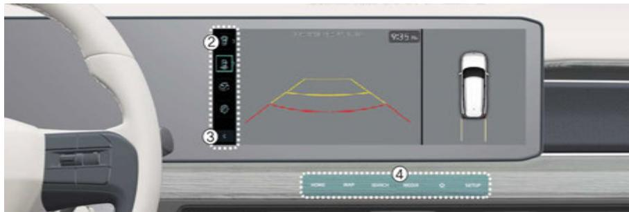
Функция фронтального обзора отображает на экране навигационной системы ситуацию впереди автомобиля в соответствии с настройками водителя, помогая безопасно ехать или парковаться.
