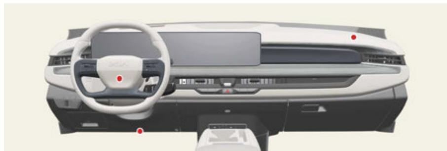
О наличии этой системы в автомобиле свидетельствует вырезанная надпись **AIR BAG** на крышке подушки безопасности рулевого колеса, на крышке коленного буфера со стороны водителя, расположенного под рулевым колесом, и на кладке передней панели со стороны пассажира над перчаточным ящиком.
