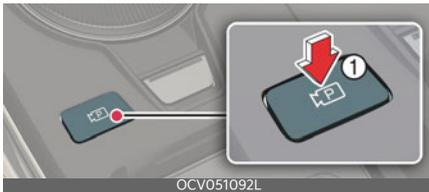
1. Esant įjungtam automobiliui, nuspauskite stabdžių pedalą ir įjunkite P (stovėjimo) arba N (neutralią) pavarą.
