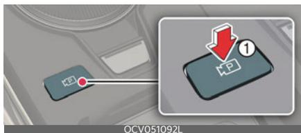
1. Esant įjungtam automobiliui, nuspauskite stabdžių pedalą ir įjunkite D (važiavimo) arba N (neutralią) pavarą.
