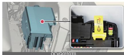
Nuleiskite geltoną aukštosios įtampos išjungiklio svirtelę žemyn ir atjunkite aukštosios įtampos akumulatorių.
