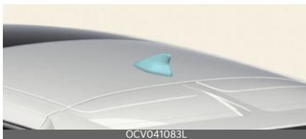
Stogo antena perduoda ir priima belaidžio ryšio signalus, tokius kaip AM / FM, DAB, GNSS, LTE ir kt.
