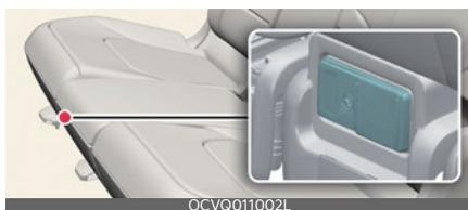
2. Mechaniniu raktu atrakinkite elektros lizdo dangtelį.
